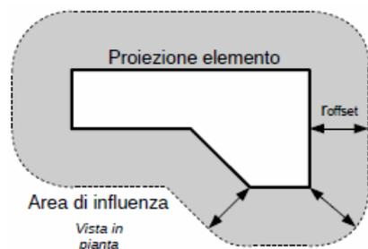
Illustrazione G.1-2: Costruzione dell'area di influenza di un elemento, in pianta
