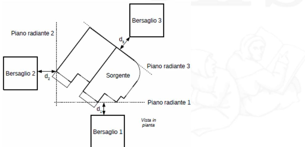
Illustrazione S.3-1: Determinazione del piano radiante, vista in pianta delle costruzioni
