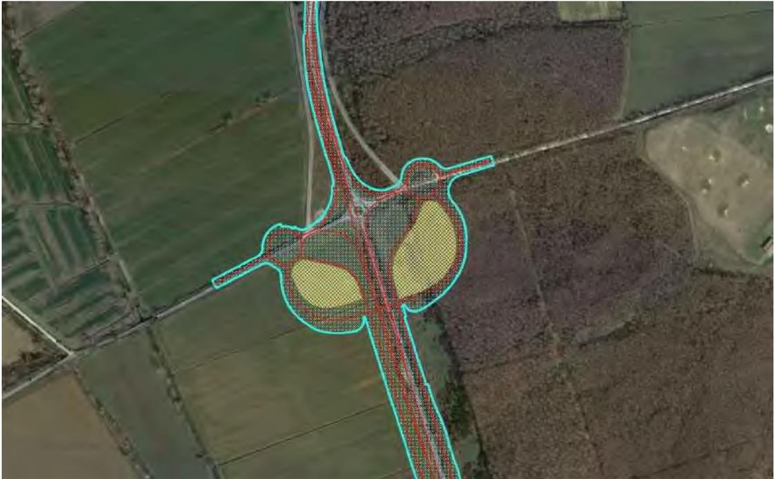
Figura 5 – Esempio di ingombro (in ciano) di un'opera stradale (in rosso) con aree di cantiere (in giallo)
