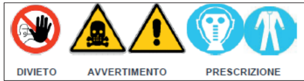
Figura 7 - Esempi di segnalazione di aree a rischio
